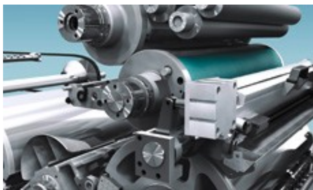
ROLAND 200 H с InlineCoater smart – системата за лакиране, разположена в последната печатна секция © manroland
