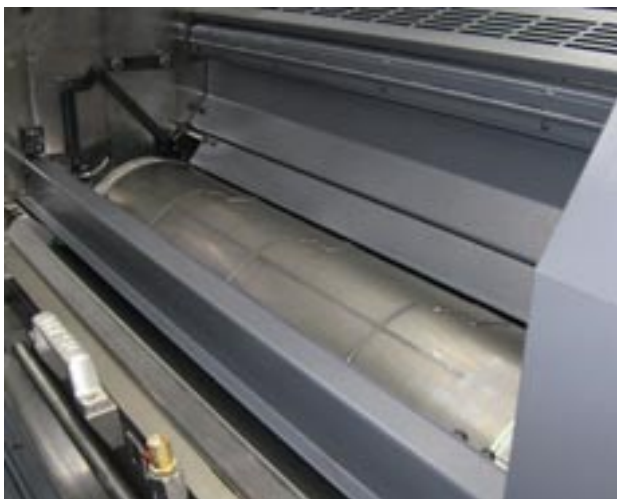
Щанцоване в лакиращия модул на ROLAND 200 с високостапелно извеждане © manroland
